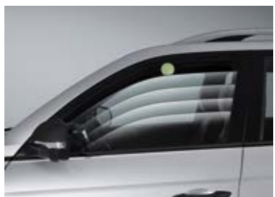
Elektrycznie sterowane szyby z zabezpieczeniem przed przycięciem palców
